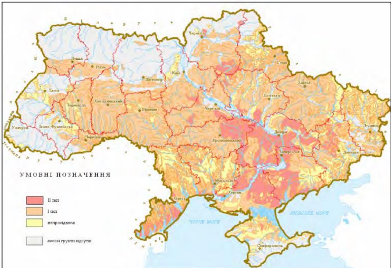
Рисунок 7.5. Поширення лесових ґрунтів з різними типами просідання
