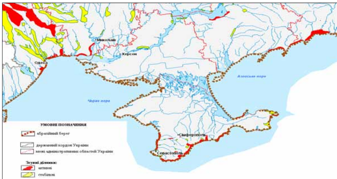
Рисунок 7.2.2.2 - Сумісний прояв абразійного та зсувного процесів протистояти розмиванню, що визначає швидкість руйнування берегів. Інтенсивність абразії змінювалась від 5,8 м 3 /пог.м у Миколаївській до 40,0 м 3 /пог.м в Одеській області.
