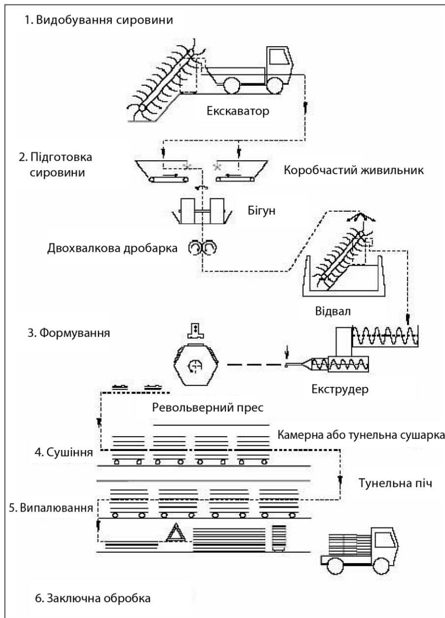
Рисунок 2.7. Схема виробництва пресованої черепиці
