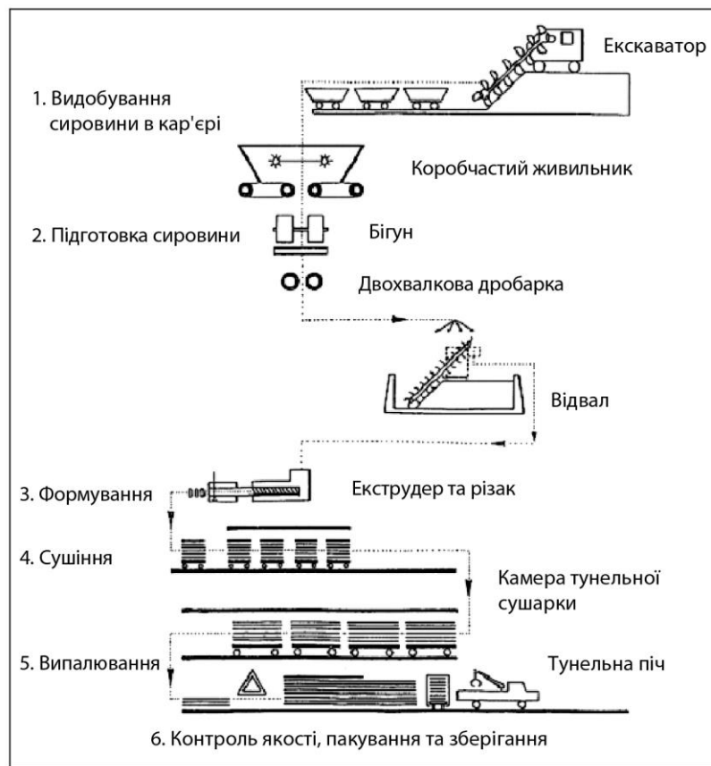
Рисунок 2.8. Схема підготовки екструдованої цегли при виробництві кладкової цегли
