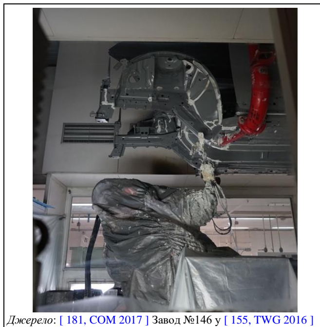
Рисунок 17.11: Роботизований аплікатор для герметика, захищений тканинним чохлам
