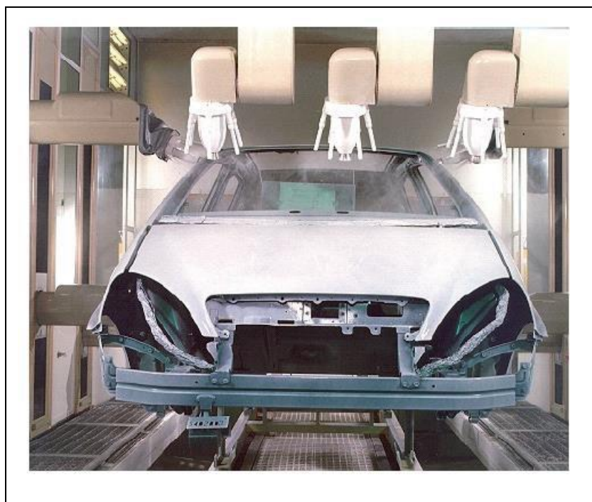
Рисунок 2.40: Автоматизоване нанесення фарби за допомогою фарбувальних машин
