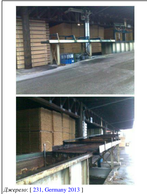
Рисунок 15.28: Приклад краплевловлювача з розчином для обробки крапель, що стікає назад у ємність для обробки
