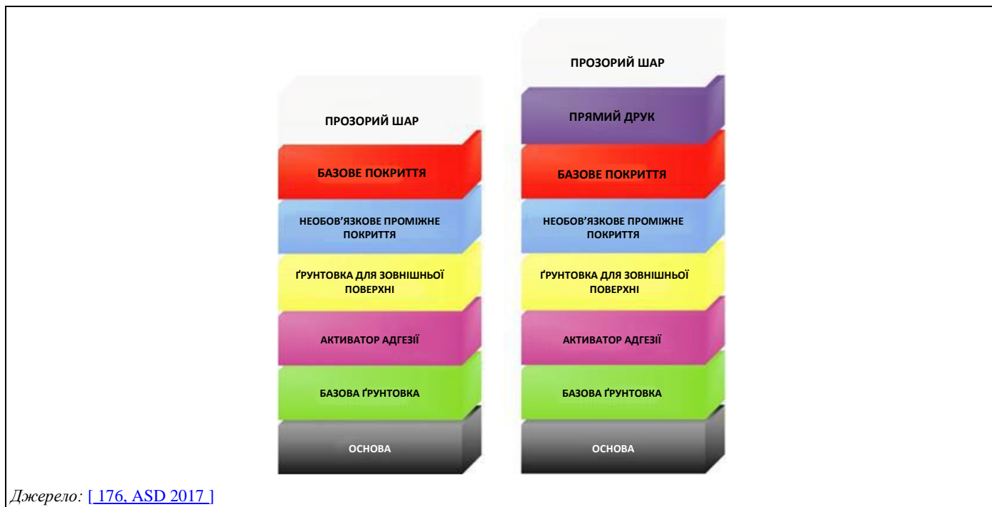
Рисунок 5.11: Порівняння системи БПП (базове покриття / прозоре покриття) з прямим друком у системі БПП
