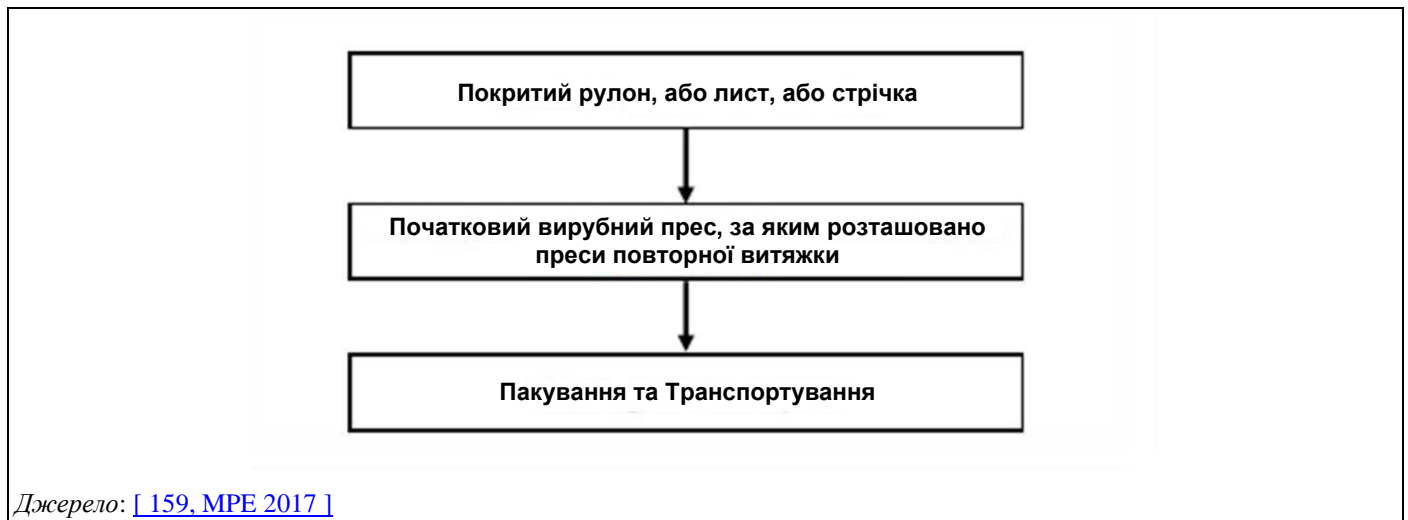
Рисунок 10.7: Послідовність виробництва тягнених збірних банок із двох деталей
