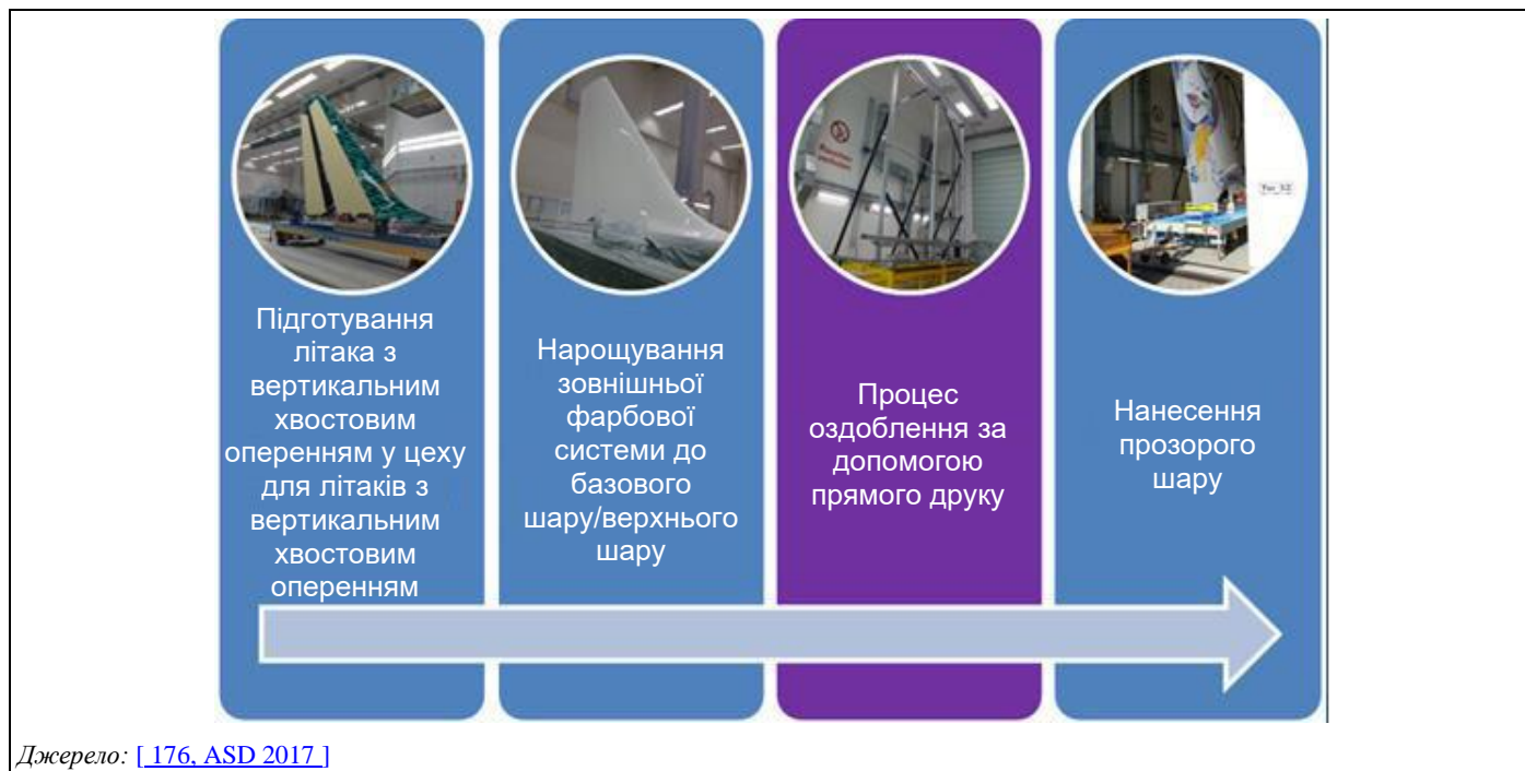
Рисунок 5.10: Ланцюг технологічного процесу, включно з прямим друком
