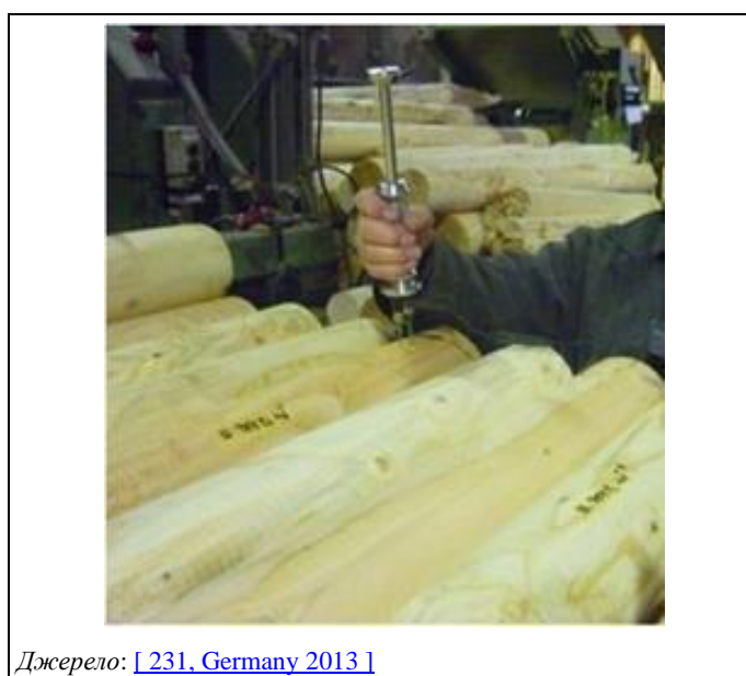
Рисунок 15.27: Ручне вимірювання вологості деревини
