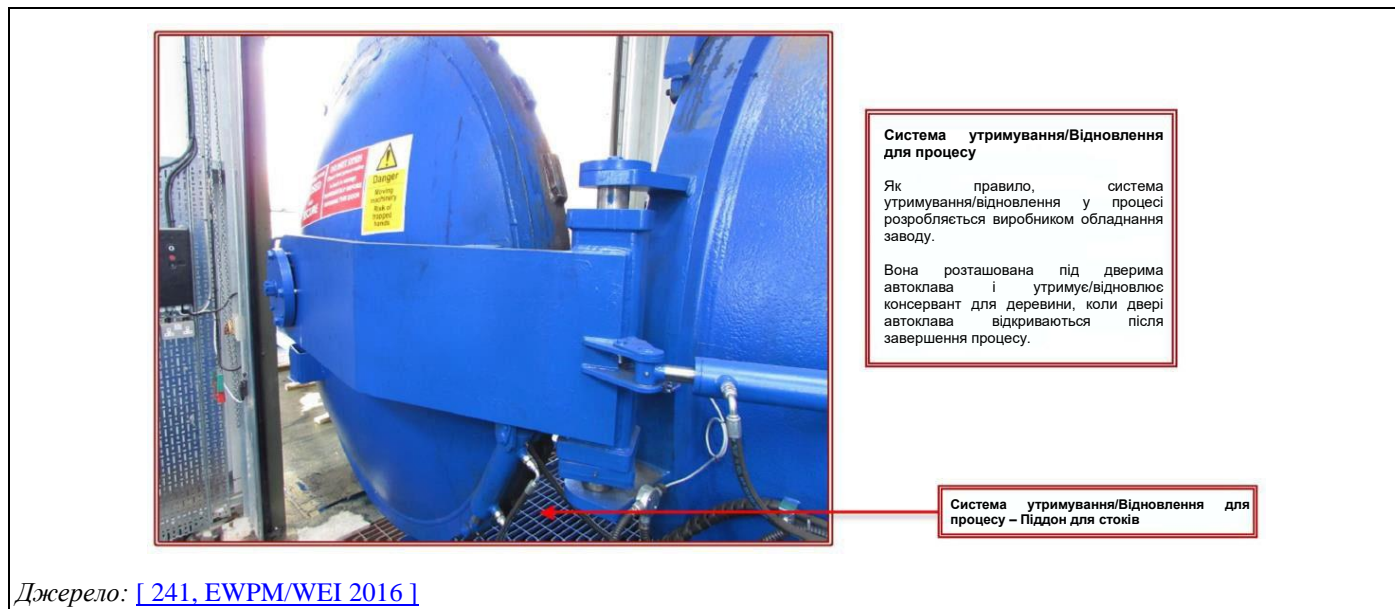
Рисунок 15.23: Приклад піддона під дверима автоклава
