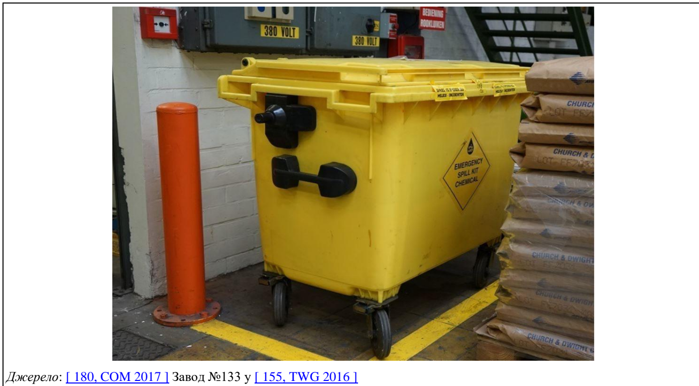
Рисунок 17.2: Пристрій для збору розливої рідини в транзитній зоні між зонами зберігання та виробництва
