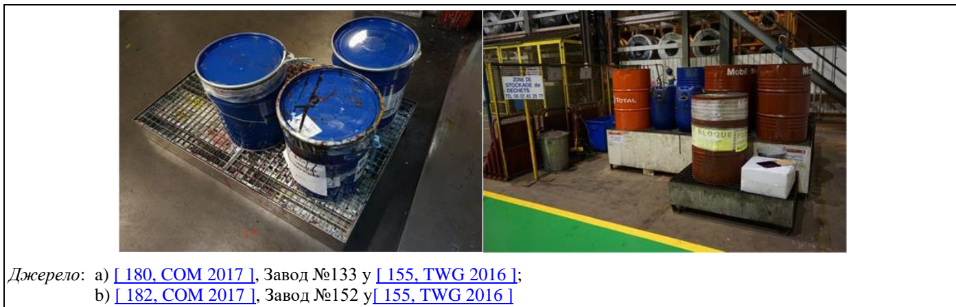
Рисунок 17.3: Вбудована система утримування для переміщення та зберігання барабанів у виробничих зонах
