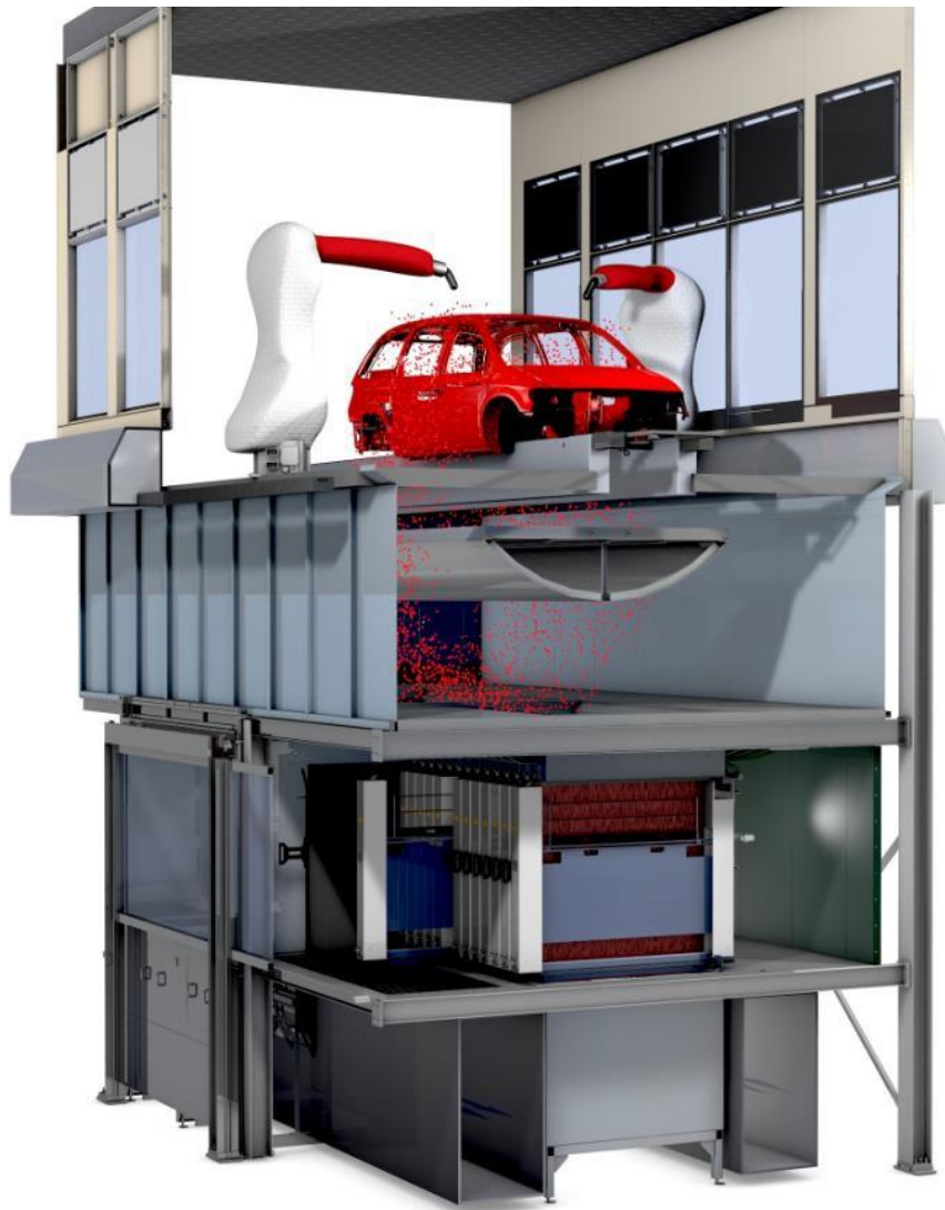
Рисунок 2.45: Система промивного електростатичного фільтра
