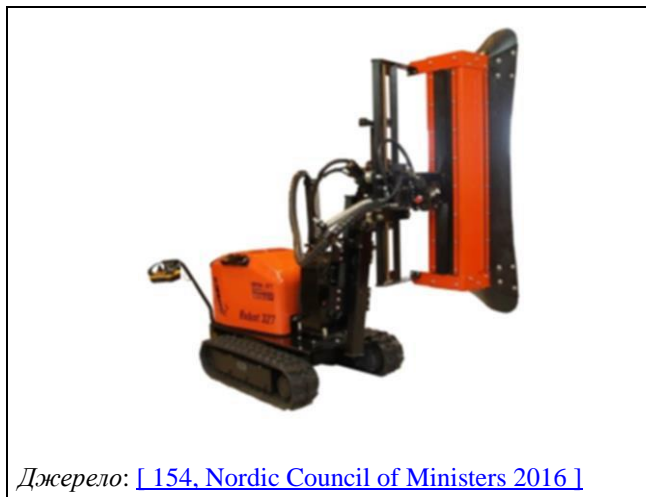
Рисунок 4.3: Корпус навколо наконечника трубки в деяких більш вдосконалених моделях роботів
