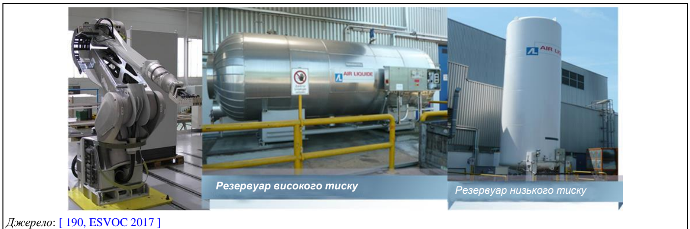
Рисунок 17.14: (а) Робот-аплікатор, (б) Резервуар з CO 2 високого тиску, (с) Резервуар з CO 2 низького тиску
