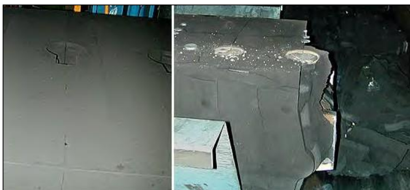
Рис. 2.43: Вибивання в кінці автоматизованої формувальної виробничої лінії [237, Гельсінський університет технологій (НУТ), 2003]
