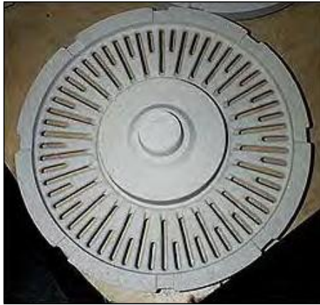
Рис. 2.32: Ливарні стрижні, виготовлені у холодних ящиках [237, Гельсінський університет технологій (HUT), 2003]
