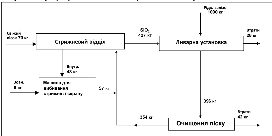
Рис. 4.27: Оперативні дані щодо циклу використання піщаної суміші для ливарного виробництва із сирової суміші у Нідерландах [140, Тематична мережа ЄС відходи ливарного виробництва, 2001 рік]
