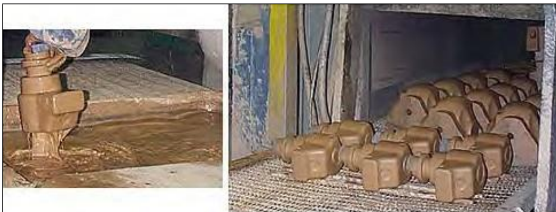
Рис. 2.35: Покриття методом занурення із застосуванням покриття на водній основі з подальшим сушінням у печі з гарячим дуттям [237, Гельсінський університет технологій (НУТ), 2003]
