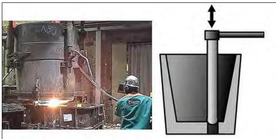
Рис. 2.41: Стопорний розливний ківш для заливання розплавленого металу [237, Гельсінський університет технологій (HUT), 2003]
