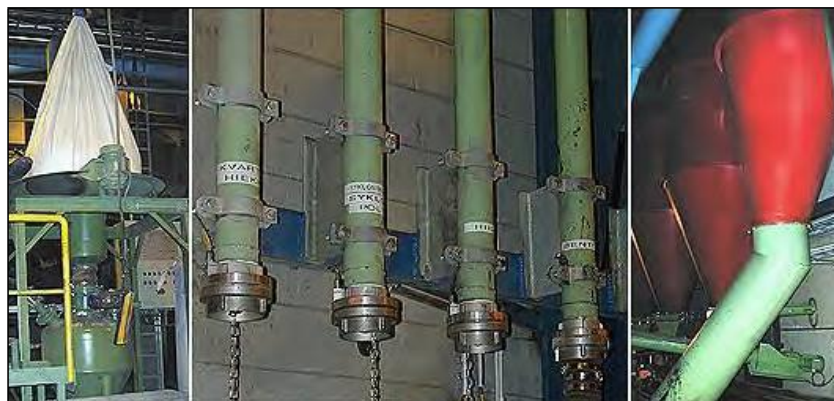
Рис. 2.8: Пневматичні конвеєри та силоси для порошкоподібних матеріалів [237, Гельсінський університет технологій (НУТ), 2003]
