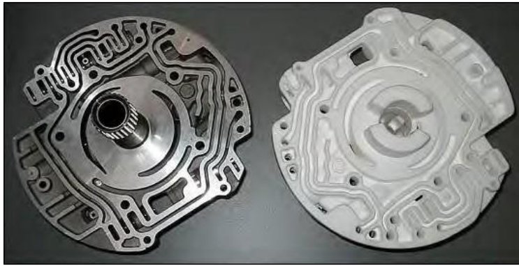
Рис. 2.37: Одноразові моделі (г.) для процесу ЛГМ і як приклад лиття відповідно до методу ЛГМ (л.) [237, Гельсінський університет технологій (HUT), 2003]
