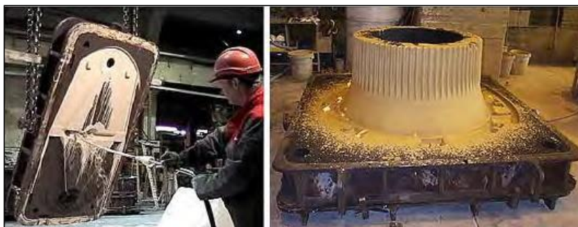
Рис. 2.34: Покриття методом обливання із застосуванням покриття на спиртовій основі з подальшим випалюванням або сушкою [237, Гельсінський університет технологій (НУТ), 2003]
