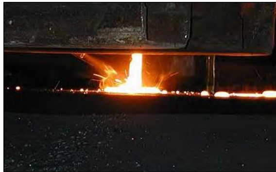
Рис. 2.24: Графітизуюче модифікування під час заливання [237, Гельсінський університет технологій (НУТ), 2003]
