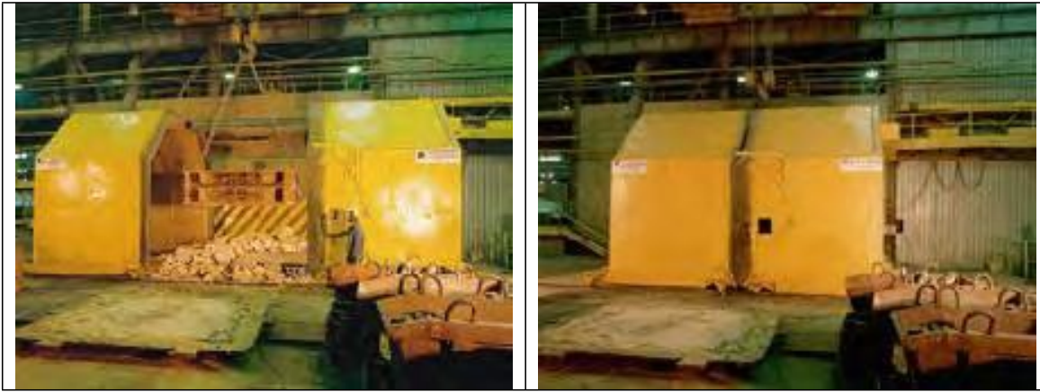
Рис. 4.17: Кожух для решітки для вибивання, для виливків із великих партій [209, Metalodlew s.a., 2003]
