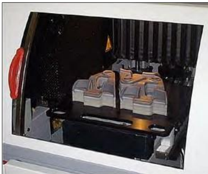
Рис. 2.6: Термополімерні (воскові) моделі в машині для швидкого виготовлення прототипів, зразків, моделей [237, Гельсінський університет технологій (HUT), 2003]
