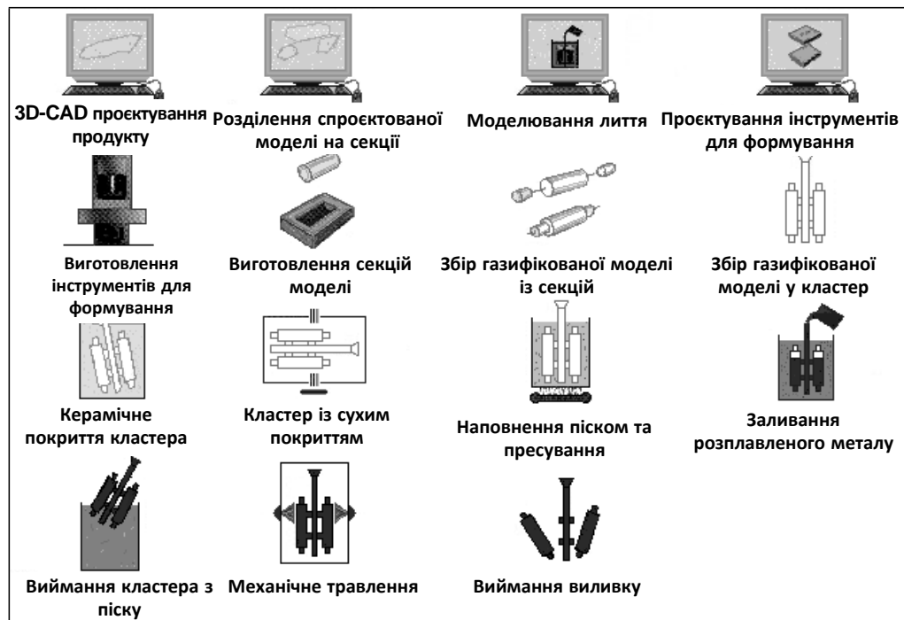
Рис. 2.36: Процес лиття по газифікованих моделях [110, Віто, 2001]
