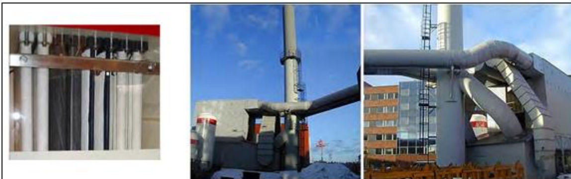
Рис. 4.10: Елементи мішкового фільтру; вид зсередини (л.) та зовні (п., г.) [237, НУТ, 2003].
