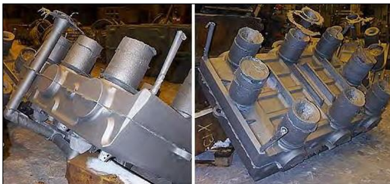
Рис. 2.49: Лиття з литниковою системою [237, Гельсінський університет технологій (НУТ), 2003]
