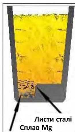
Рис. 2.23: Метод сандвіча для сфероїдизування [237, Гельсінський університет технологій (HUT), 2003]
