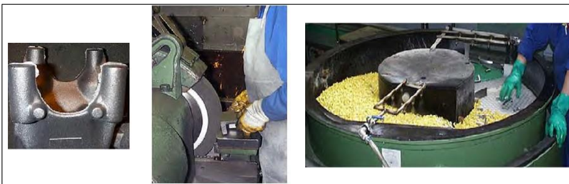
Рис. 2.51: Задирки (а.) та їх усунення шліфувальним каменем (б.) та ковзким шліфуванням (в.) [237, Гельсінський університет технологій (НУТ), 2003]
