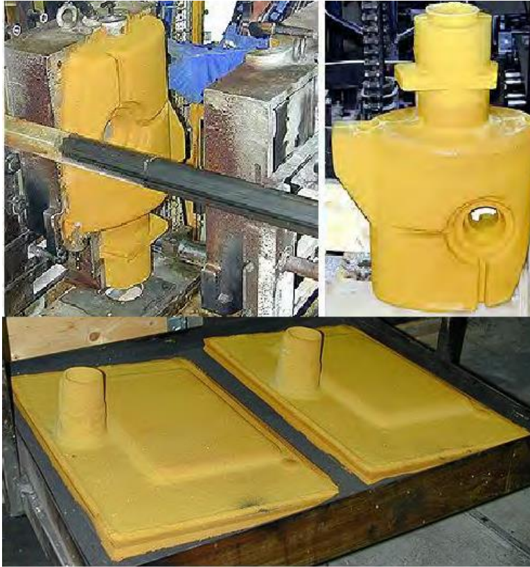
Рис. 2.33: Стрижні (зверху) та форми (знизу), виготовлені із суміші піску і термореактивних фенольних смол [237, Гельсінський університет технологій (НУТ), 2003]
