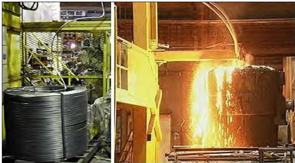
Рис. 2.22: Розкиснювання з використанням алюмінієвих дротів [237, Гельсінський університет технологій (HUT), 2003]
