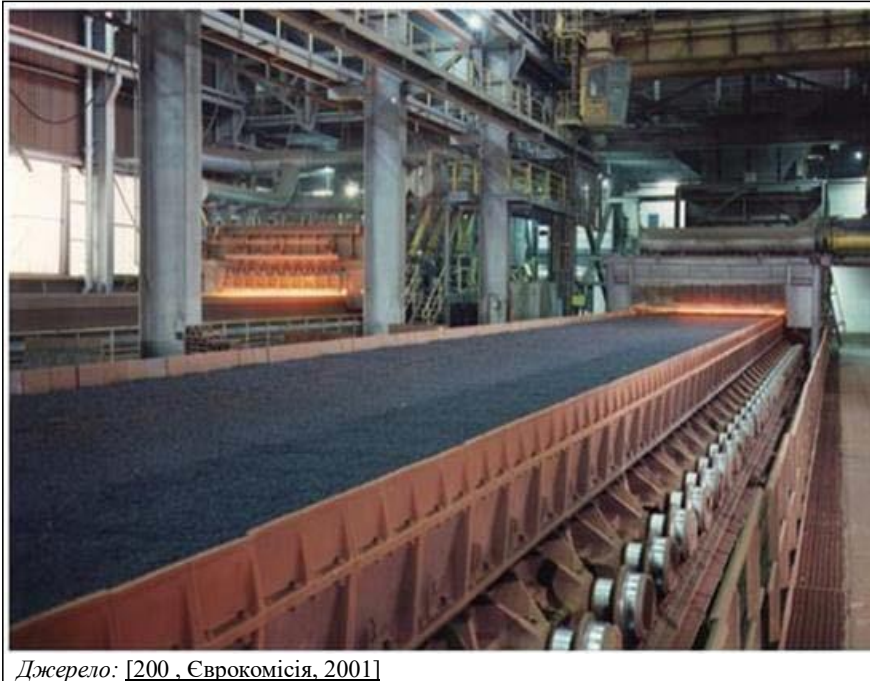
Рис. 3.1. Фотографія агломераційної стрічки із системою завантаження (барабани або жолоби) і запальовального горну
