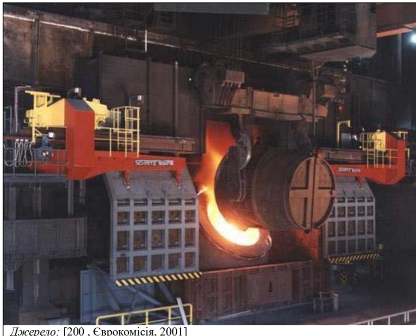
Рис. 7.1. Кисневий конвертер у момент розливання рідкої сталі
