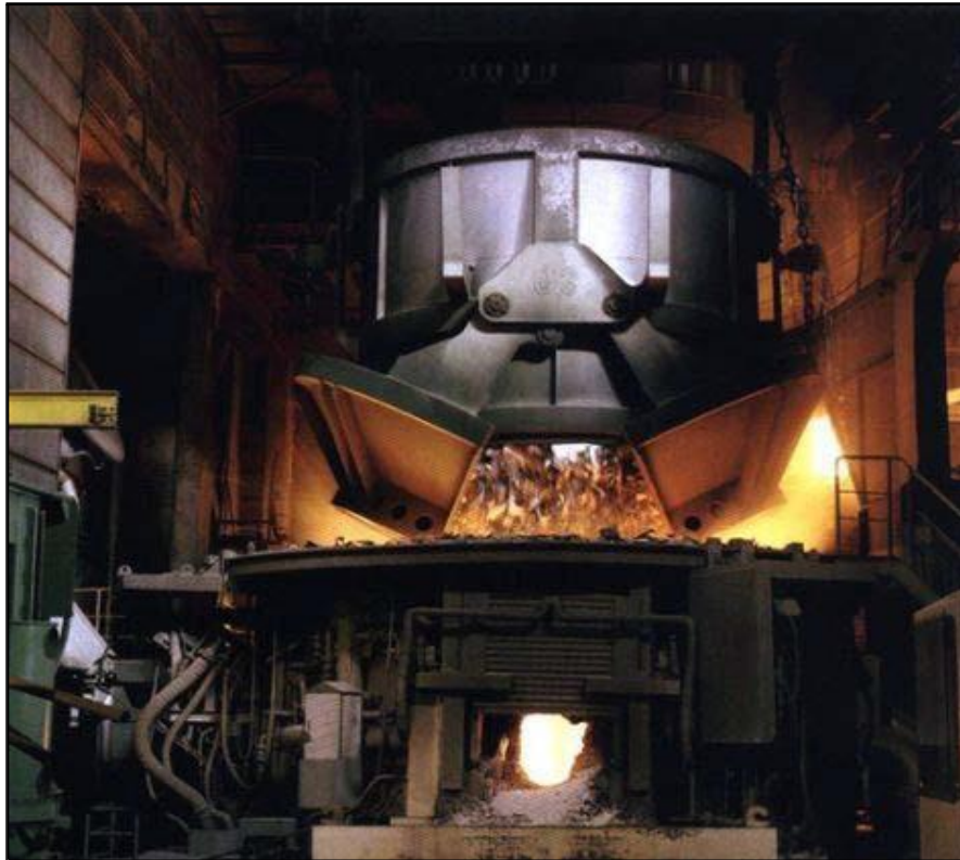
Рис. 8.2. Завантаження електродугової печі
