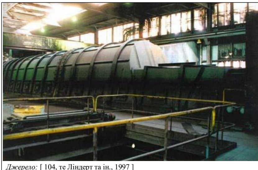
Рис. 3.21. Агломераційна стрічка з накриттям відповідно до процесу EOS (викиди при оптимізованому спалюванні)
