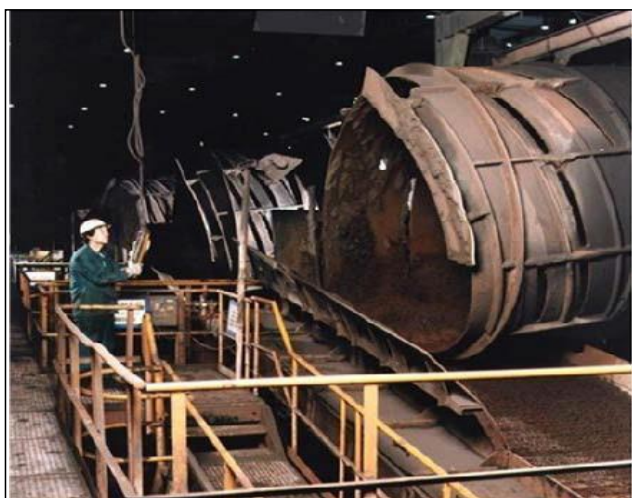
Рис. 4.1. Барабанний окомковувач як частина установки для отримання окаатишів, на яку виходять сирі окаатиші
