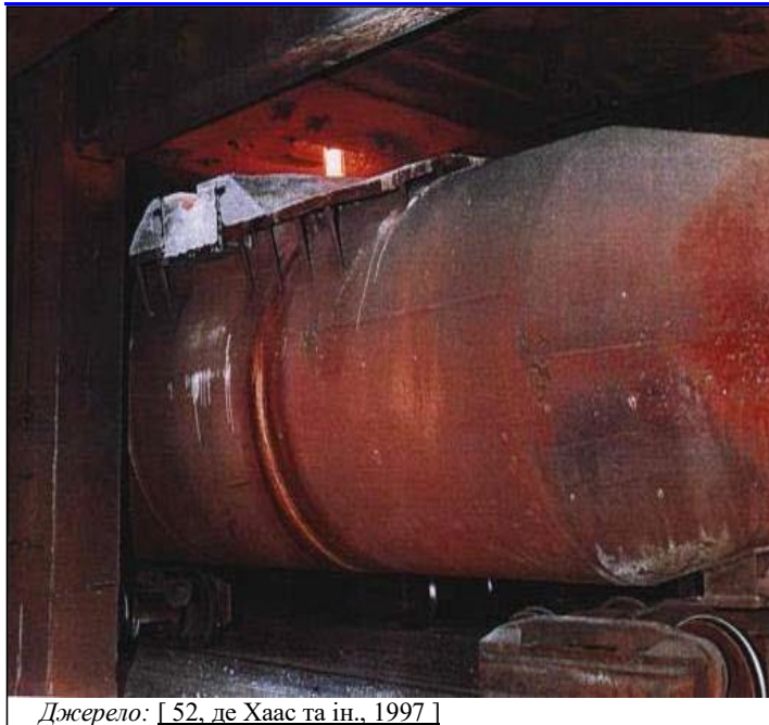
Рис. 6.16. Розлив чавуну в ківш сигароподібної форми з придушенням утворення пилу завдяки продувці інертним газом
