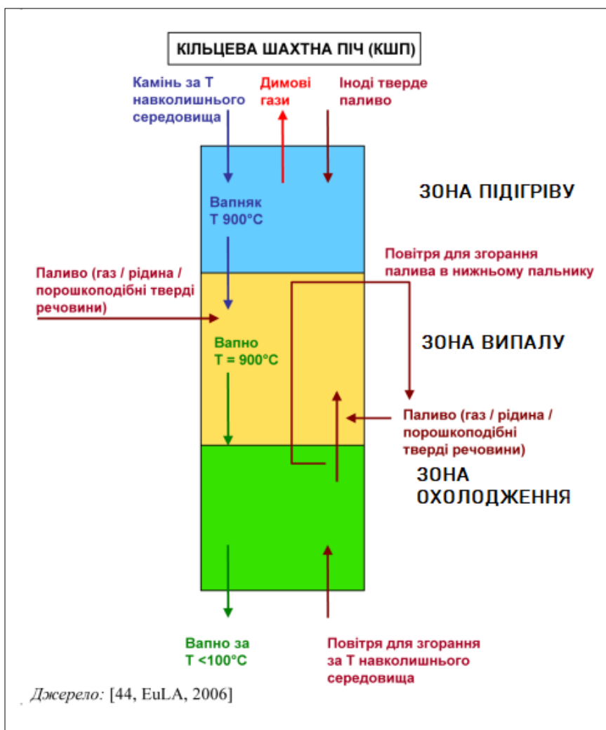
Рисунок 2.27. Принцип роботи кільцевих шахтних печей (КШП)
