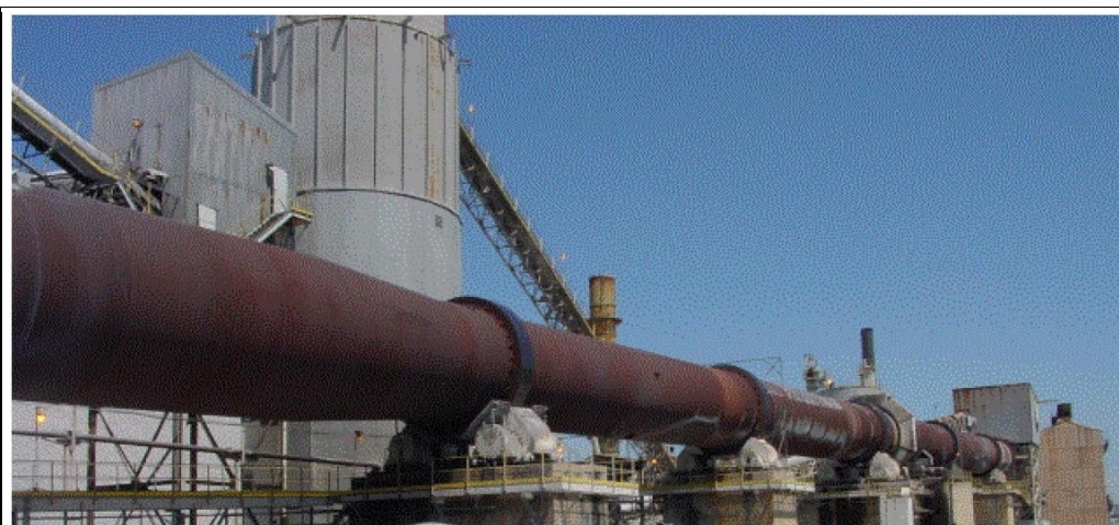
Рисунок 2.31. Приклад довгої обертової печі, що використовується у виробництві вапна
