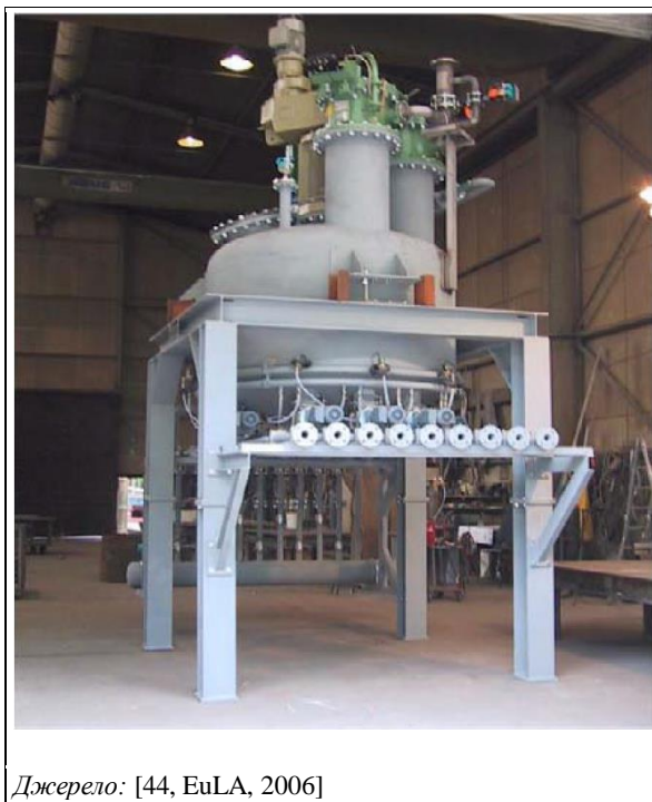
Рисунок 2.11. Приклад дозувальної системи шахтної печі
