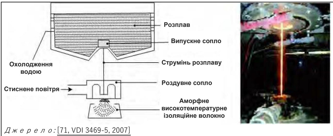
Рисунок 2.14. Метод паралельного роздування
