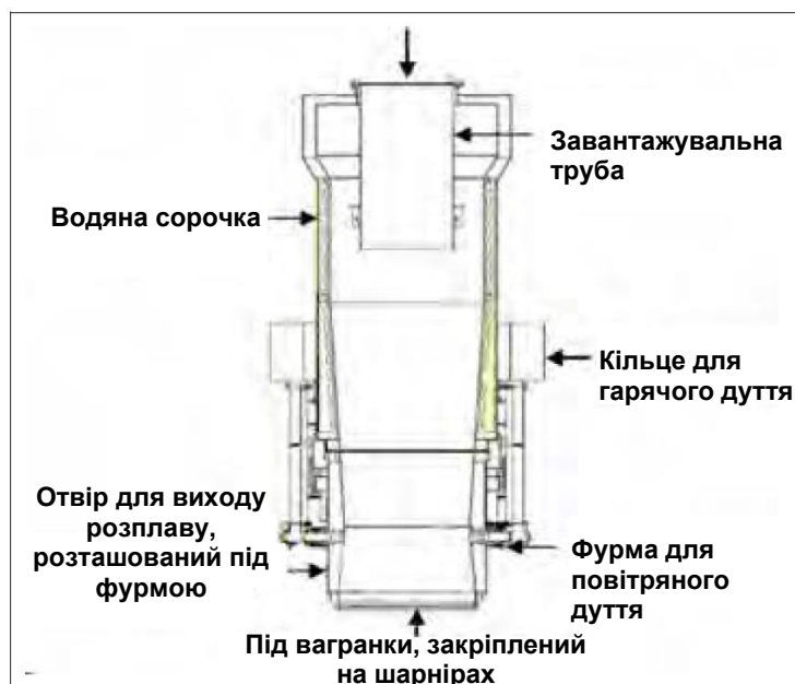
Рисунок 2.13. Типова вагранка з гарячим дуттям
