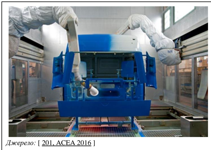
Рисунок 2.14: Фарбування кабіни вантажного автомобіля
