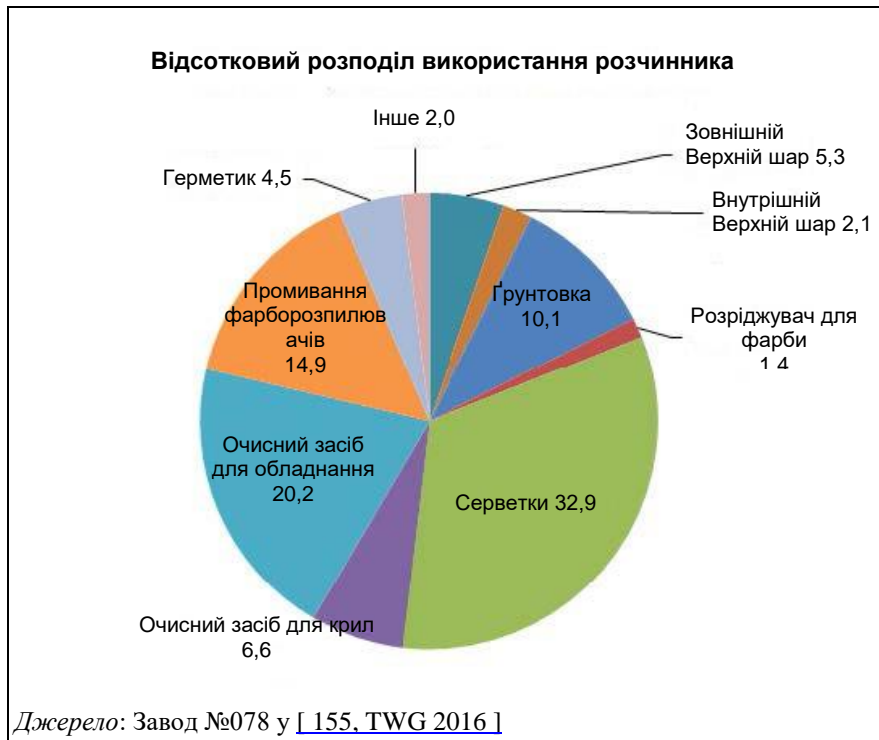
Рисунок 5.3: Відсотковий розподіл використання розчинника за процесами для однієї установки (виробництво компонентів)
