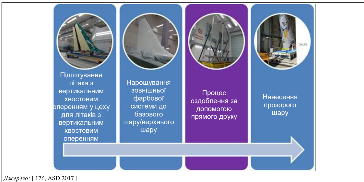
Рисунок 5.10: Ланцюг технологічного процесу, включно з прямим друком
