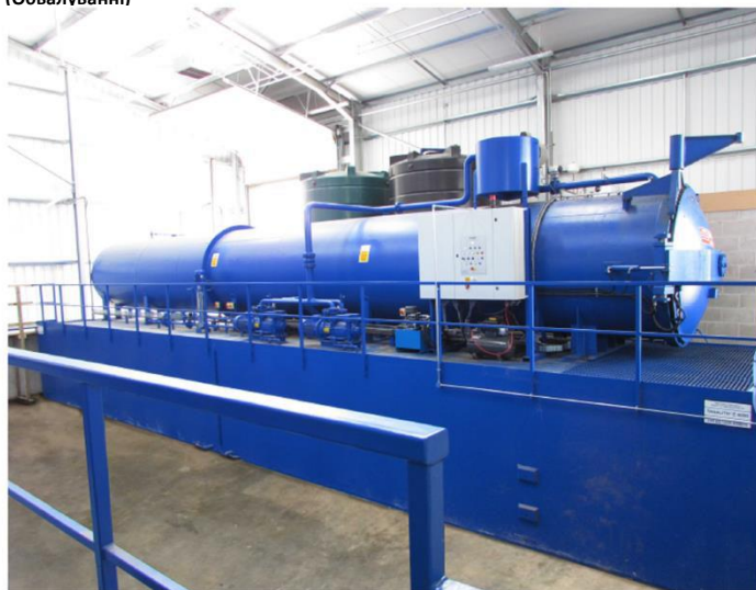
Рисунок 15.22: Приклади конструкцій для систем утримування для процесу
