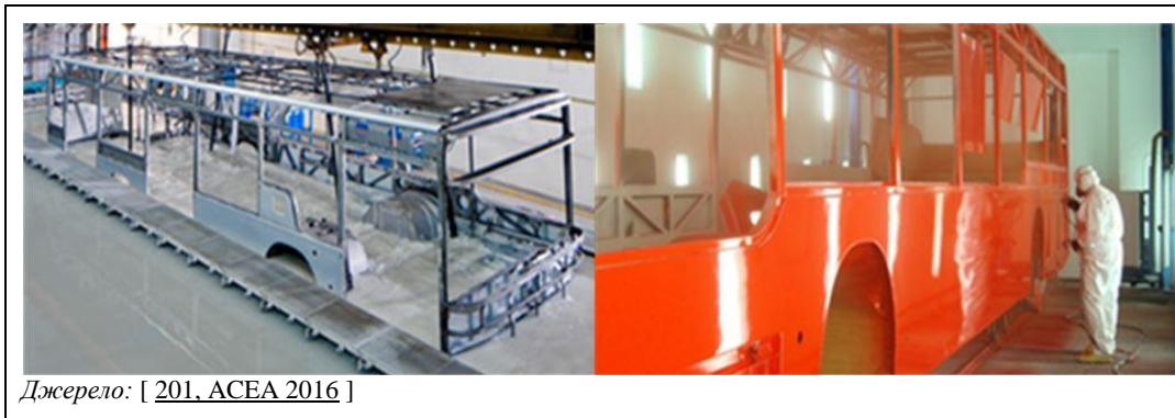
Рисунок 2.16: Операції нанесення покриття на автобуси: електроосадження покриття (ліворуч) та верхній шар (праворуч)
