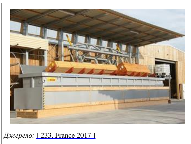
Рисунок 15.5: Приклад короткочасного занурення (короткострокове занурення/занурення на певний час) – резервуар, що дає можливість одночасно обробляти декілька акумуляторів із кріпленням на стендах поряд із резервуарами для занурення
