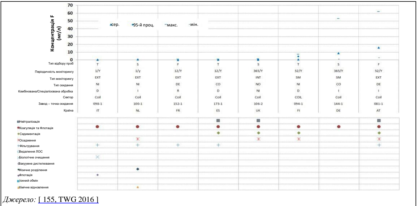
Рисунок 6.16: Значення концентрації фторидів для прямого та непрямого скидання стічних вод заводів із нанесення покриття на рулонний метал (дані за 2015 р.)
