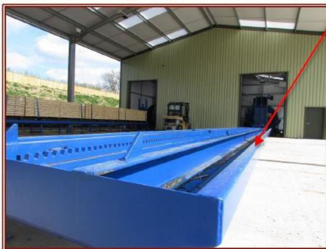
Рисунок 15.24: Приклад піддона, вбудованого в систему розвантаження (під зоною вилучення)
