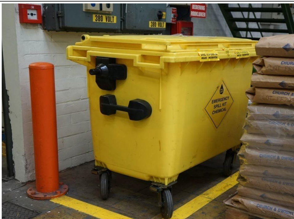
Рисунок 17.2: Пристрій для збору розливої рідини в транзитній зоні між зонами зберігання та виробництва
