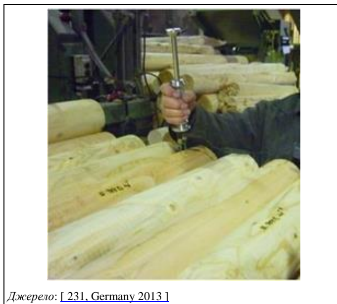
Рисунок 15.27: Ручне вимірювання вологості деревини
