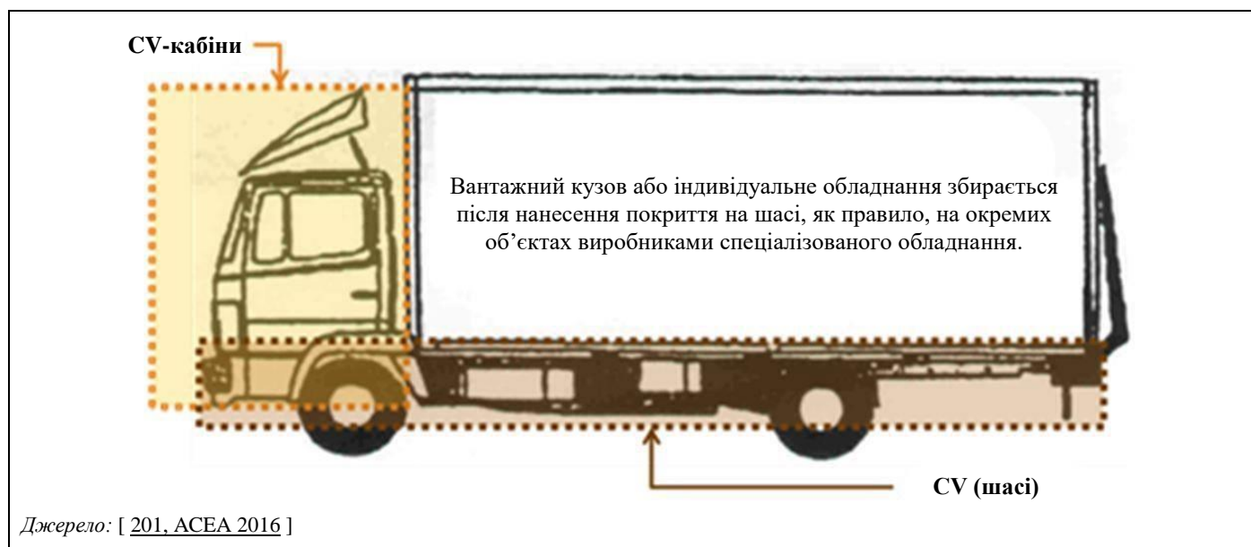
Рисунок 2.12: Типова конструкція вантажного автомобіля (окремі відсіки для водія та вантажу)
