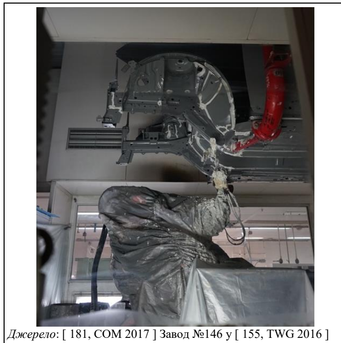
Рисунок 17.11: Роботизований аплікатор для герметика, захищений тканинним чохлам
