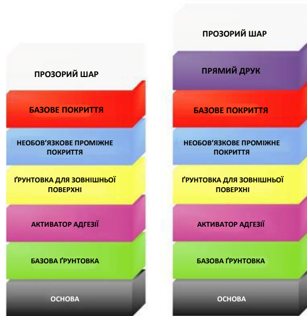
Рисунок 5.11: Порівняння системи БПП (базове покриття / прозоре покриття) з прямим друком у системі БПП
